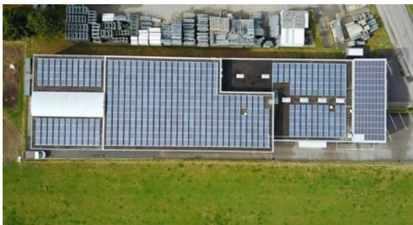
PV-Anlage auf Industriedach, 984 m<sup>2</sup>, 150 kWp. Direkt zugänglich, keine Absturzsicherung vorhanden. Angebotener Preis: **ca. Fr. 3'700.00** mit Reinigung mittels Roboter und Osmosewasser.
